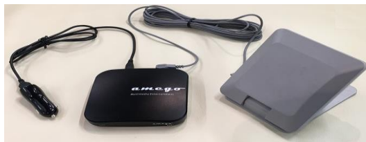
(1) USB 直流5V输入（车载插头）(2) Amego盒, (3) 天线 (1) USB 直流5V输入（汽车插头）(2) Amego盒, (3) 天线
