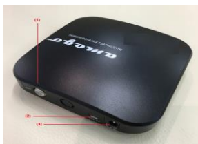
1) 天線輸入, (2) USB (車載插頭), (3) 12V (牆上插頭) (1) USB 直流5V輸入 (汽車插頭), (2) Amego盒, (3) 天線
