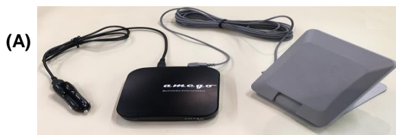
1) 天線輸入, (2) USB (車載插頭), (3) 12V (牆上插頭) (1) USB 直流5V輸入 (汽車插頭), (2) Amego盒, (3) 天線
